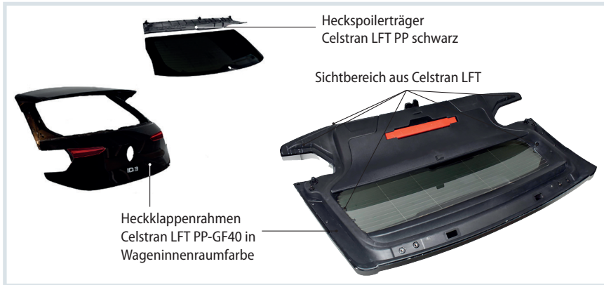
Bild 4. Da sich die Anforderungen an den Träger der Heckklappe und des Heckspoilers unterschieden, wurden diese mit unterschiedlichen Werkstoffen umgesetzt. Quelle: A2MAC1; Grafik: © Hanser
