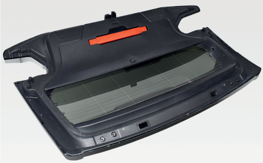
Bild 2. Bei einem Teil der Heckklappe handelt es sich um ein Innenraumbauteil. Die verwendeten FVK haben eine sehr gute Oberflächenqualität und müssen deshalb nicht extra lackiert werden. Sie werden als voreingefärbte Granulate in der gewünschten Farbe des Innenraums ausgeliefert.
